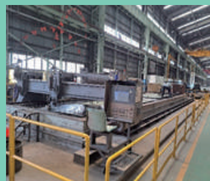
水刀切割機 切割床台尺寸：最大 13m(長)x3.3m(寬) 起重能力：最大 20 噸
