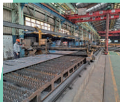
CNC 火焰切割機 切割床台尺寸： 最大 45m(長)x3m(寬) 起重能力：最大 20 噸
