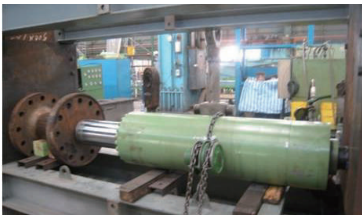
中鋼 W3 油壓缸試壓 \text{Ø}280\text{mm} \times 200\text{mm} \times 650 CSC W3 Hydraulic Cylinder Pressure Test \text{Ø}280\text{mm} \times 200\text{mm} \times 650
