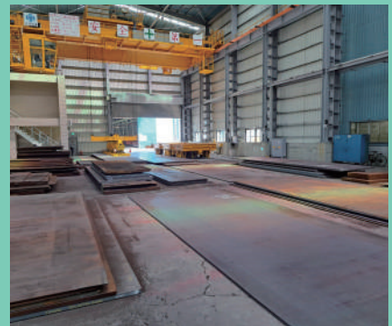
鋼板室內儲區 室內面積：最大 75m(長)x20m(寬) 起重能力：最大 20 噸
