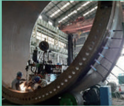
自動潛弧焊機 自動潛弧焊接能力：最大電流 1,250A 工件：8,000mm(直徑)
