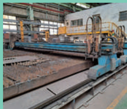
電離子切割機 切割床台尺寸：最大 50m(長)x9m(寬) 起重能力：最大 20 噸
