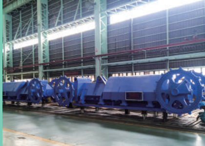
台中電廠連續式卸船機橫向伸縮架 TPC CSU Telescopic Frame
