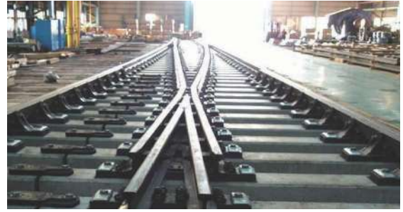
道岔設備 Turn-out system
