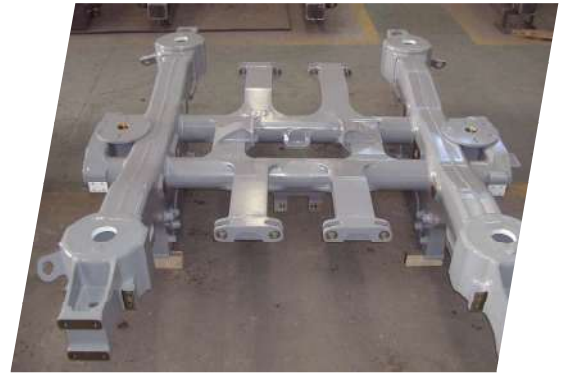
日本車輛 台鐵普悠瑪傾斜電聯車轉向架框 Nippon Sharyo TRA Tilting EMU bogie frame
