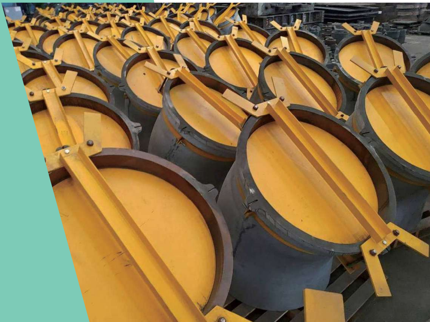
廢氣彎管 Bent pipe
