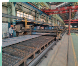
CNC 火焰切割機 切割床台尺寸： 最大 45m(長)x3m(寬) 起重能力：最大 20 噸 CNC flame cutting machine Capacity of cutting table for steel plate: max. 45m (L) x3m (W) Capacity of lifting for steel plate: max.20 ton
