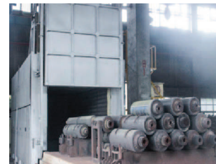
600KW 電熱爐 600KW electrical annealing furnace
