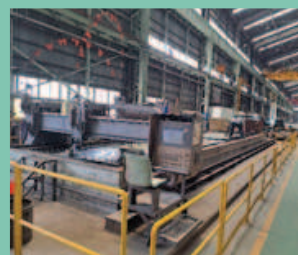
水刀切割機 切割床台尺寸：最大 13m(長)x3.3m(寬) 起重能力：最大 20 噸 Water Jet Cutting Machine Capacity of cutting table for steel plate: max. 13m (L) x3.3m (W) Capacity of lifting for steel plate: max.20 ton
