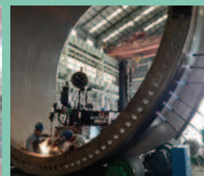
自動潛弧焊機 自動潛弧焊接能力：最大電流 1,250A 工件：8,000mm(直徑) Automatic arc welder Capacity of auto-submerged arc welding: max. current: 1,250A Work piece: 8,000mm (Dia.)
