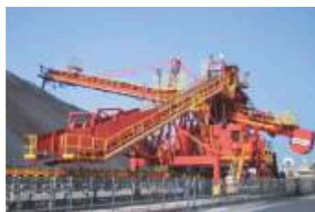
中龍堆料機 DSC 450/800/250 T/H Stacker
