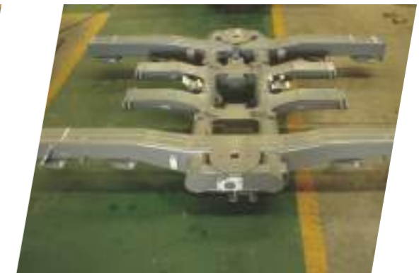
日本車輛 台鐵 800 型電聯車轉向架框 Nippon Sharyo TRA EMU800 bogie frame
