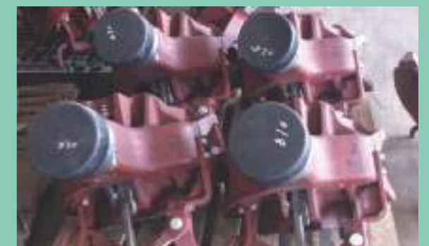
密著式聯結器 Tight lock type coupler
