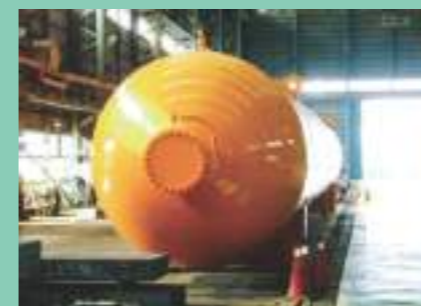
中龍 高壓氧氣儲槽 DSC Hyperbaric oxygen tank
