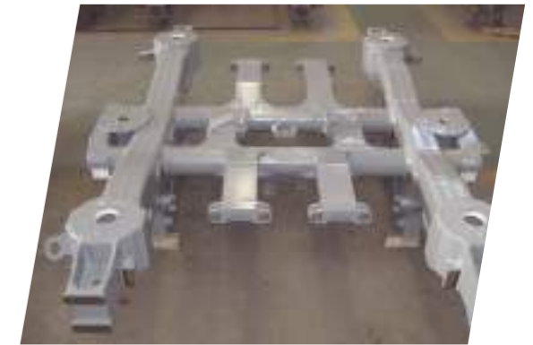
日本車輛 台鐵普悠瑪傾斜電聯車轉向架框 Nippon Sharyo TRA Tilting EMU bogie frame
