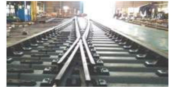
道岔設備 Turn-out system
