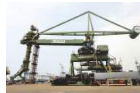
台塑河靜連續式卸船機 2,400 T/H CSU for Formosa Ha Tinh Steel Corporation
