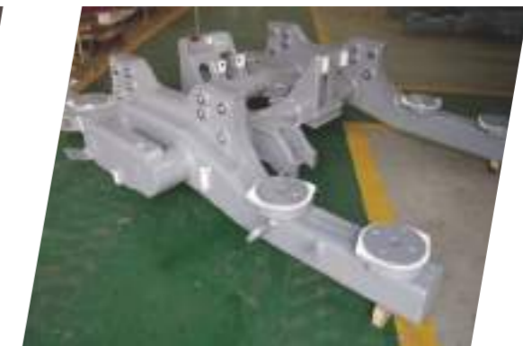
日本車輛 台鐵 700 型電聯車轉向架框 Nippon Sharyo TRA EMU 700 bogie frame
