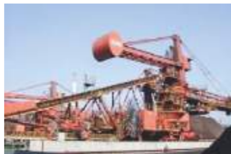
中龍堆取料機 DSC 4,500/2,500 T/H Stacker/Reclaimer
