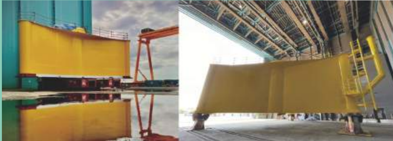
水下基礎轉接段 Transition Piece (TP)
