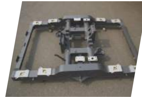
川崎重工 北捷信義松山線電聯車轉向架框 Kawasaki Heavy Taipei Metro Xinyi-Songshan line EMU bogie frame
