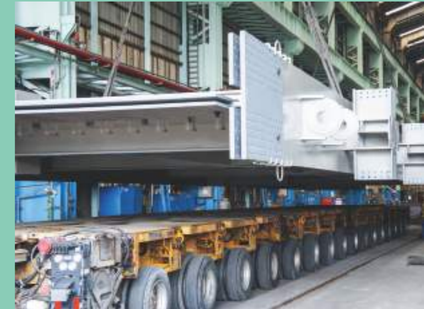
台電大林電廠鍋爐大樑 TPC Talin Top girder
