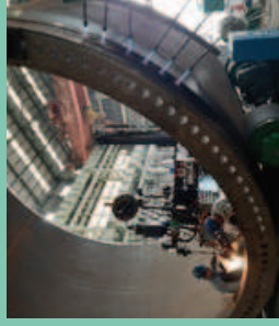
自動潛弧焊機 自動潛弧焊接能力：最大電流 1,250A 工件：8,000mm(直徑) Automatic arc welder Capacity of auto-submerged arc welding: max. current: 1,250A Work piece: 8,000mm (Dia.)
