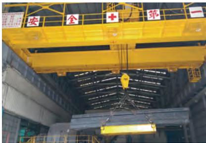
中鋼機械專注於 E、F 等級天車承製，擁有 EPC 的能力，從機電設計、採購、製作、假組立、運送、安裝及工檢作業，提供客戶一個完整的解決方案，在大型熔銑天車、架空式天車、門型天車、懸臂式天車、特殊起重天車，在鋼鐵廠、電廠、及核電廠等領域皆有輝煌實績。相較於傳統的電控方式，新型天車使用 IGBT(絕緣柵雙極型電晶體，Insulated Gate Bipolar Transistor) 來控制輸出頻率達到調速的目的，另外搭配 PLC (可程式控制器，Programable Logic Controller) 控制器可大大的節省線材及電氣元件的使用，以符合環保的要求。
