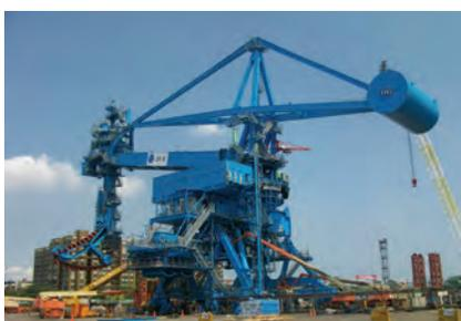
在鋼鐵生產的輸送設備方面，中鋼機械的產品項目有：連續卸船機、堆取料機及輸送帶設備...等。新型連續式卸船機，不僅讓卸船效率大為提升，同時可降低卸船落料、粉塵污染、油污及噪音等環保問題，也是中鋼集團推動環保工廠的一大創舉。新型連續式卸船機雖然造價較舊型卸船機昂貴許多，但中鋼集團在推動與落實環保工作上向不遺餘力，為追求永續發展，善盡社會責任，對此項新型卸船機的投資仍然覺得非常值得。
